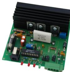
Kundenspezifische Ladeelektronik für zwei Lithium-Ionen -Akkus 7,2V 2,4Ah.
